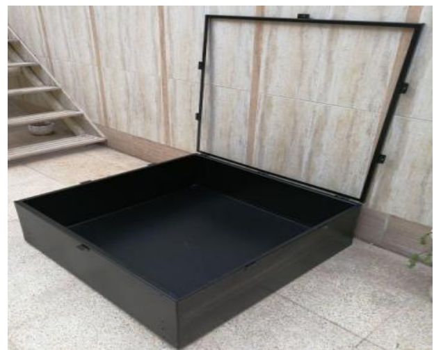
شکل ۲: قاب متحرک نصب شده روی حوضچه جهت قرار گیری پوشش شیشه ای
